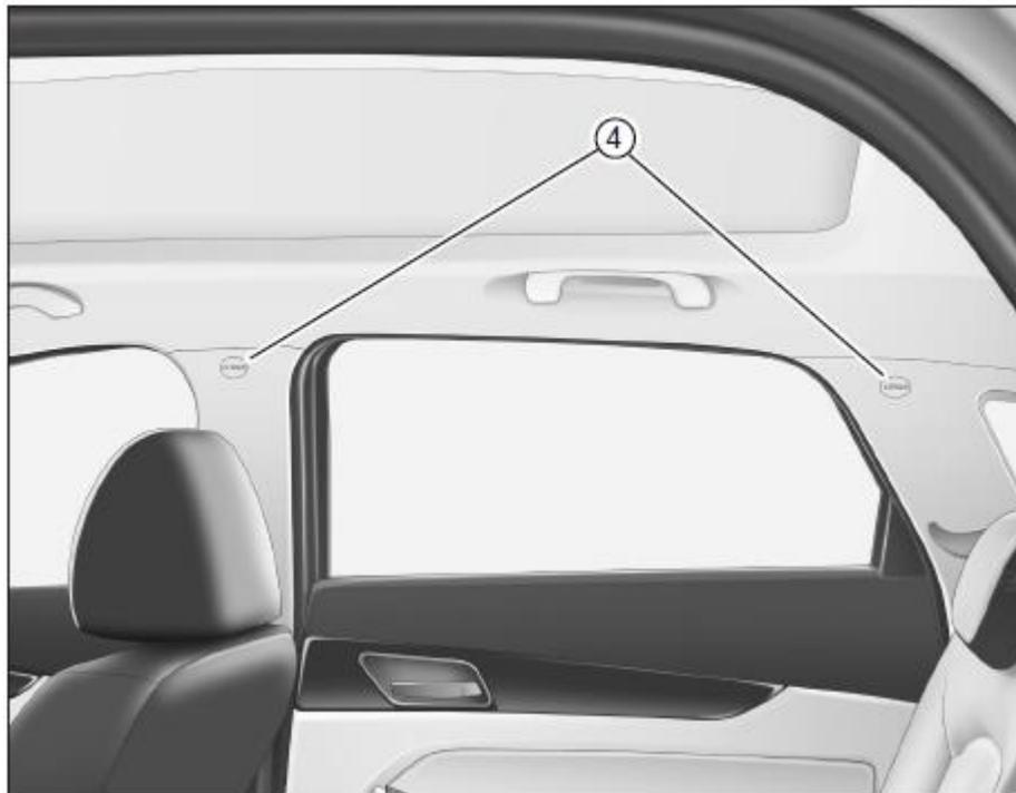
Bolsas de aire laterales tipo cortina 4 Ubicadas cerca del techo a ambos lados de la viga. Las palabras "AIRBAG" están marcadas en los pilares B y C.
