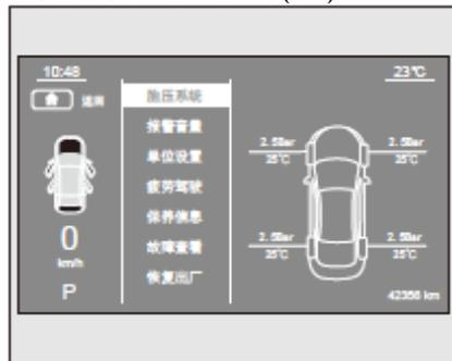
Ingrese la configuración del instrumento para ver la información del neumático, la información del neumático muestra la presión y la temperatura del neumático.
