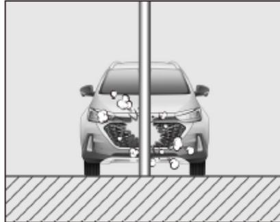
Si el vehículo choca con algún objeto muy delgado, como un poste o un árbol, en tal colisión, el punto de impacto se concentra en un lugar y la energía del impacto se absorbe rápidamente a través de la deformación severa del vehículo, y el sensor de airbag puede no desplegarse sin que se transmita la fuerza de impacto total.
