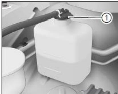
Verifique el nivel de refrigerante después del enfriamiento del motor. Si encuentra falta de refrigerante, puede abrir el tapón de llenado del depósito de refrigerante ① y agregar refrigerante a la posición entre las marcas de límite superior e inferior.
