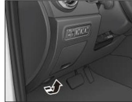
1. Tire de la manija de apertura de la cubierta del compartimento del motor en el extremo delantero del umbral del lado del conductor en la dirección de la flecha. El capó se desbloquea y el capó abrirá ligeramente.
