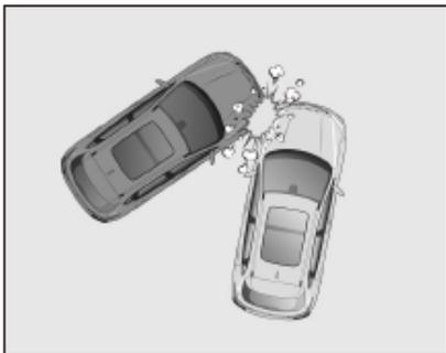
Cuando se produce una colisión oblicua, la energía de impacto recibida por el sistema de airbag puede no ser suficiente para activar el despliegue del airbag frontal, y en este momento, el airbag frontal puede no desplegarse, y el airbag lateral y la cortina lateral pueden no funcionar.
