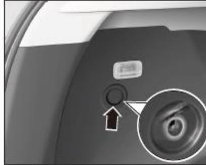
Cuando el lado izquierdo de la caja de equipaje está equipado con una de salida de 12V y una toma de entrada de potencia máxima de 120W, Cuando el botón de inicio / parada sin llave se encuentra en modo ACC o RUN, la toma de entrada se alimentará.
