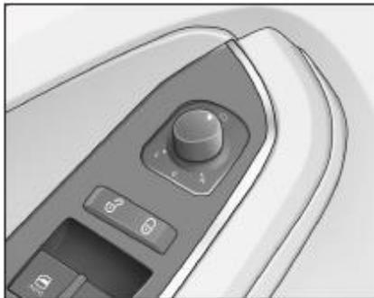
Gire la perilla de ajuste a la posición **9**, y luego los espejos retrovisores exteriores en ambos lados se despliegan automáticamente al mismo tiempo.
