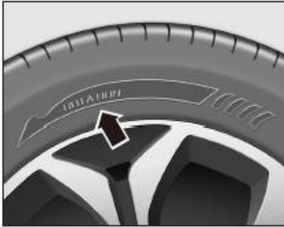
La dirección de instalación del neumático se puede identificar por la dirección indicada por la flecha lateral del neumático en la banda de rodamiento, y contiene la palabra "ROTACIÓN". Se debe asegurar que las ruedas giren en la dirección indicada por la flecha a medida que el vehículo se mueve hacia adelante.
