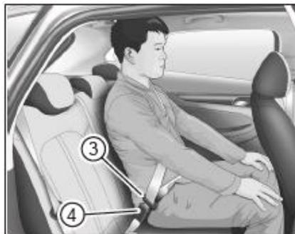
Siéntese derecho en el asiento y ajuste el respaldo lo más posible al respaldo del asiento. Pase el seguro del cinturón de seguridad 3 por la cadera. Inserte la lengüeta en la hebilla 4 y asegure el cinturón de seguridad. Sujete las secciones superior e inferior del cinturón de seguridad y ajústelas ligeramente para que el viaje sea más cómodo y seguro. Para desbloquear el cinturón de seguridad, presione en la hebilla 4 el botón rojo, luego se puede quitar la lengüeta de bloqueo 3.
