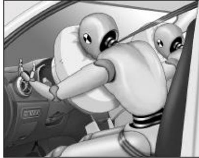
En caso de una colisión grave con un vehículo, la bolsa de aire se expandirá rápidamente en muy poco tiempo y luego se desinflará y se contraerá para aliviar el impacto inercial del cuerpo humano. Por lo tanto, el conductor y el pasajero deben mantener la postura correcta y usar el cinturón de seguridad para obtener de manera efectiva la protección del airbag.
