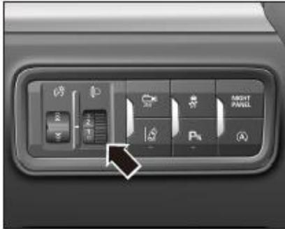
La altura de iluminación de los faros se ve afectada por la distribución del peso de los pasajeros y el equipaje en el vehículo. Asegure el ángulo visual de la carretera para proporcionar una iluminación adecuada en la parte delantera del vehículo ajustando la altura de los faros.
