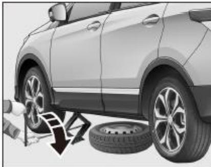
6. Gire la palanca de la gata en el sentido de las agujas del reloj y levante el vehículo con la manija de la gata y la llave de desmontaje de la rueda hasta que la rueda con falla abandone el suelo.
