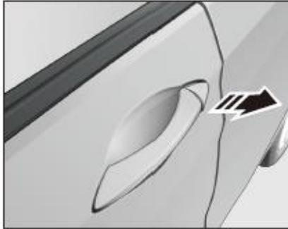
3. Retire la tapa del cilindro de la cerradura.
