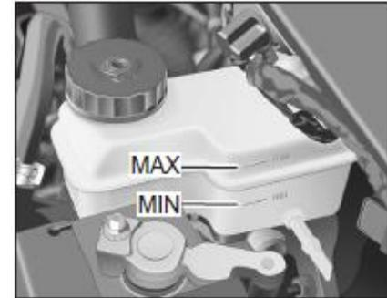
Observe la línea de marca en el depósito de líquido de frenos.
