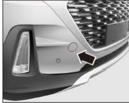
Instalación del anillo de remolque delantero
