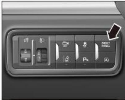
Presione el botón **NIGHT PANEL** ubicado debajo del panel de interruptores multifunción en la parte inferior izquierda del panel de instrumentos, las luces de todos los instrumentos y botones del vehículo entran en el modo nocturno.
