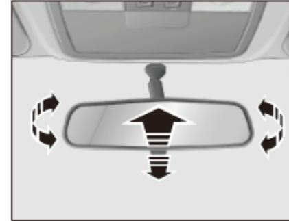
Por la noche, mueva la palanca hacia atrás en la parte baja del espejo a la posición antideslumbrante. Ajustar el espejo retrovisor interno para reducir el resplandor a los ojos por
