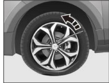
5. Afloje los pernos de fijación de la rueda con falla 1-2 vueltas en sentido antihorario con la llave de desmontaje de la rueda.
