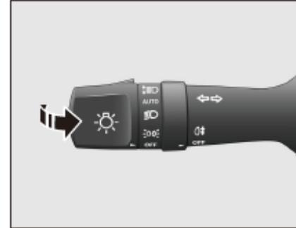
Tire del joystick de control de la luz hacia el plano del volante. La luz alta se enciende. Cuando se suelta, el joystick de control de luz regresa automáticamente y las luces altas se apagan para alertar a los vehículos y peatones que se encuentran adelante.
