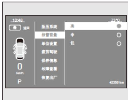
Elija "Volumen de alarma" en la página de configuración del instrumento, presione brevemente el botón **OK** para configurar el volumen de la alarma. Cambie el botón **▲** / **▼** para elegir entre "alto", "medio" y "bajo", presione brevemente el botón **OK** para completar la configuración. Luego presione brevemente **⬆** para regresar al menú superior, presione prolongadamente **⬆** para regresar al menú principal.
