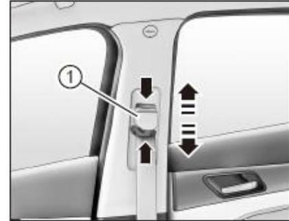
Usando el dispositivo de ajuste de altura del cinturón de seguridad, la altura del punto de apoyo en el cinturón de seguridad se puede ajustar para acomodar la altura con el hombro de diferentes ocupantes.
