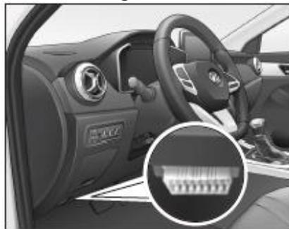
La interfaz de diagnóstico se encuentra en la parte inferior izquierda del tablero. La interfaz de diagnóstico se utiliza para la comunicación digital entre la unidad de control electrónico del vehículo y el equipo de diagnóstico, y la información del código de identificación del vehículo se puede leer a través de la interfaz de diagnóstico.
