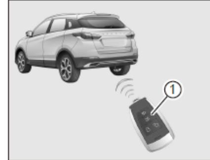
Mantenga presionado el botón de desbloqueo de la puerta del maletero 1 en la llave inteligente para desbloquear la puerta del maletero. Presione el interruptor de solicitud de la puerta del maletero nuevamente y levante la puerta del maletero para abrir.
