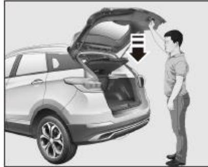
1. Sujete el asa de la puerta del maletero y tire de la puerta del maletero cerca de la posición del parachoques trasero.
