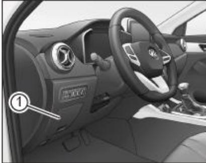
La caja de fusibles del panel de instrumentos se encuentra en la parte inferior izquierda del panel de instrumentos, y puede verla quitando la cubierta de la caja de fusibles del panel de instrumentos ①.
