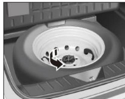
4. Desatornille el tornillo de fijación especial en el centro de la rueda de repuesto con la mano en sentido antihorario, y retire la rueda de repuesto.
