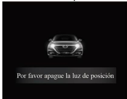
Cuando el botón de inicio / parada sin llave está en el modo "APAGADO", abra la puerta del conductor. Si la luz de posición o la luz de cruce están encendidas, el grupo de instrumentos indicará "Apague la luz de posición" en la pantalla de la computadora de manejo, junto con un pitido. Recordatorio (7 in).
