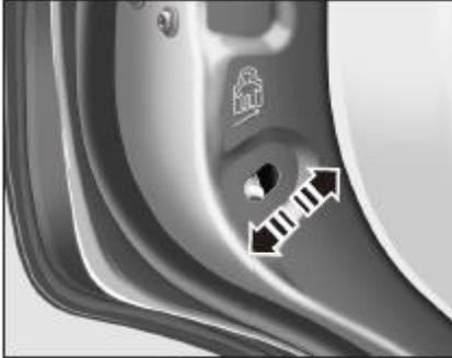
Cuando hay un niño en la fila de atrás, asegúrese de bloquearlo en el estado bloqueado. La palanca de bloqueo de seguridad para niños se inclina hacia arriba y el bloqueo de seguridad para niños está bloqueado; la palanca de bloqueo de seguridad para niños se inclina hacia abajo y el bloqueo de seguridad para niños está desbloqueado.
