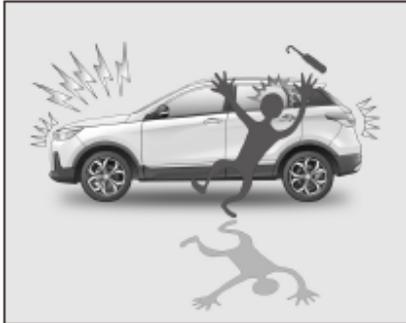
Después de que la llave inteligente lleva a cabo el bloqueo, todo el vehículo ingresa al estado armado, y todas las puertas y la tapa del compartimento del motor y la puerta del maletero están en un estado monitoreado. Si se descubre que una puerta, la tapa del maletero o el capó se abren ilegalmente, por ejemplo, si alguien abre la puerta por la fuerza, se activará la alarma.
