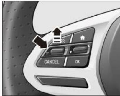
Cuando el control de crucero se detiene, mueva el botón de configuración de velocidad de crucero hacia arriba **RES** para colocar y mantener presionado durante 1-2 segundos, presionar Set / - SRC volver a ingresar al estado de control de crucero, la velocidad de crucero volverá a la velocidad de control de crucero previamente guardada antes de detenerse.
