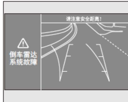
Cuando el sistema de radar de estacionamiento está activado, si el sistema detecta la información de falla, el instrumento combinado enviará un mensaje de sonido (5 in) o un mensaje de texto (7 in). Al mismo tiempo, la pantalla mostrará la interfaz de aviso de falla.
