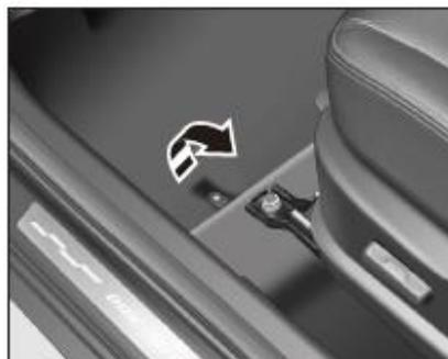
La manija de apertura de la puerta de llenado de combustible se encuentra en el piso interior del lado del conductor.
