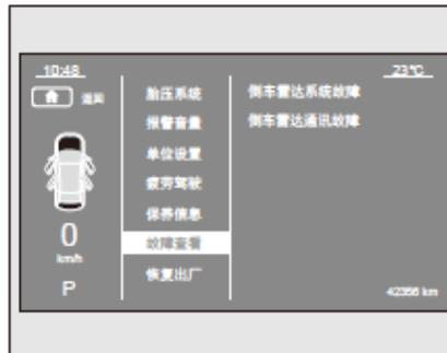
Cuando se muestra información de advertencia de alarma en la interfaz del instrumento, esta información se almacenará automáticamente en la página de mal funcionamiento. Seleccione "Mal funcionamiento", presione brevemente **OK** para ingresar a la interfaz de mal funcionamiento, cambie el botón **▲/▼** para verificar la información de mal funcionamiento, si hay una falla, vaya a los distribuidores de BAIC para verificar y reparar; si no hay falla, se mostrará "sin falla".
