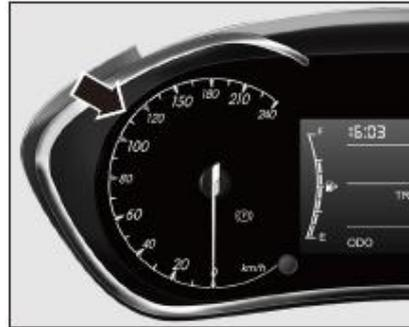
El velocímetro indica la velocidad instantánea del vehículo (unidad: km / h)
