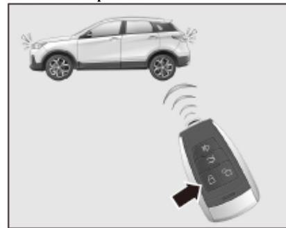
Con todas las puertas, el capó y la puerta del maletero cerrados, presione el botón de bloqueo y todas las señales de giro parpadearán una vez, y el espejo retrovisor externo se pliega automáticamente (si esta función está equipada). Verifique que todas las puertas estén bien cerradas.
