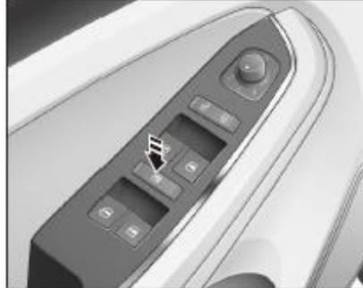
En el estado presionado de interruptor de prohibición de elevación de la ventana del lado del pasajero, los interruptores de elevación de los vidrios de las ventanas del pasajero delantero y de los pasajeros traseros no podrán controlar la elevación del vidrio de la ventana. El interruptor del elevador de la ventana del lado del conductor aún puede controlar el elevador de la ventana de cada puerta. Presione el interruptor nuevamente para liberar la prohibición, y el interruptor subirá.
