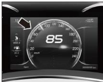
El velocímetro indica la velocidad instantánea del vehículo (unidad: km/h).
