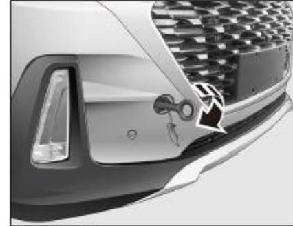
3. Atornille el anillo de tracción completamente en sentido horario en el orificio de montaje del anillo de remolque.
