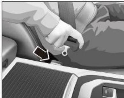
Hale lentamente el cinturón de seguridad del retractor, luego inserte la lengüeta de seguridad en la hebilla hasta escuchar el cierre de "clic", luego tire del cinturón de seguridad para confirmar un bloqueo confiable.
