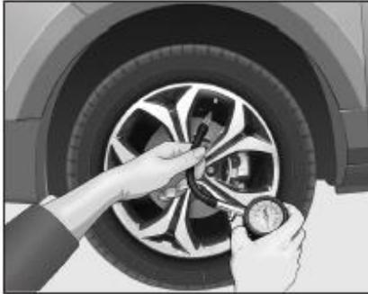
2. Coloque el medidor de presión de los neumáticos contra la válvula con fuerza, y el medidor mostrará la presión de los neumáticos.
