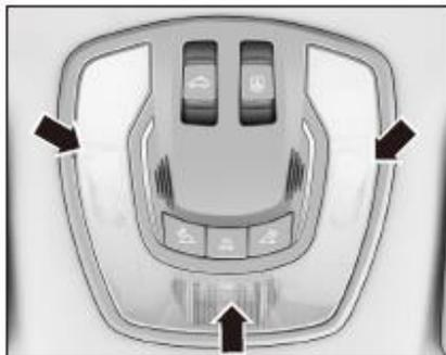
Presione el interruptor
