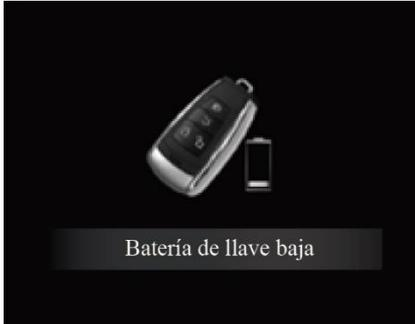
Cuando la batería de la llave inteligente es baja, la pantalla de la computadora de manejo mostrará “La batería de la llave inteligente baja. (panel de instrumentos de 7 in), le recordamos que reemplace la batería.
