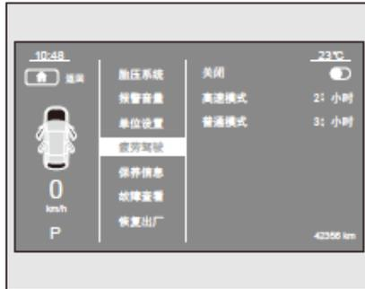
Elija "Conducción de fatiga" en la página de configuración del instrumento, presione brevemente el botón **OK** para ingresar. Cambie el botón **▲** / **▼** para elegir entre "encendido / apagado", "alta velocidad" y "normal", presione brevemente el botón **OK** para completar la configuración. Luego presione brevemente **🏠** para regresar al menú superior, presione prolongadamente **🏠** para regresar al menú principal.
