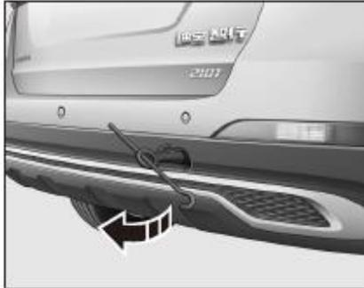
4. Apriete el anillo de remolque de forma segura con la llave de desmontaje de la rueda.
