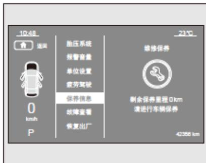
La información de mantenimiento muestra el kilometraje antes de la próxima mantención. El primer kilometraje de mantención del vehículo es de 5000 km, la mantención de reserva es de 5000 km y, ocasionalmente, se sugiere verificar para mantener la mantención a tiempo. Mantenga presionado el botón **OK** durante 30 segundos para restablecer el kilometraje de mantención.
