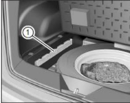
El triángulo de advertencia se coloca en la esquina inferior izquierda ① de la alfombra del maletero. Levante el cordón de la alfombra del maletero y levante la alfombra para poder verla.
