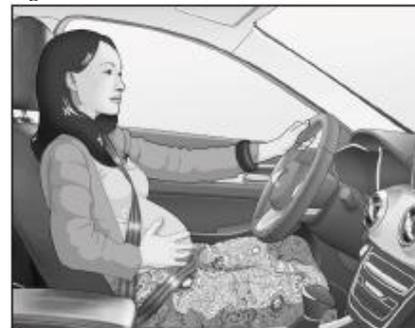
Si el conductor es una mujer embarazada, para garantizar la seguridad de la mujer embarazada y el feto, el cinturón de seguridad debe pasar uniformemente por el pecho y usarse lo más bajo posible frente a la cadera, y luego aplanarse para que la parte inferior del abdomen puede estar libre de prensado.
