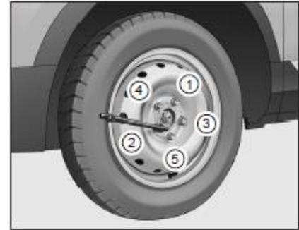
4. Apriete los pernos de fijación de la rueda en el sentido de las agujas del reloj con la llave para pernos de la rueda, no use ninguna otra herramienta, como un martillo y una tubería, y asegúrese de que la llave entre completamente en el perno.
