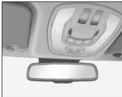
Por la noche, el espejo retrovisor interior con atenuación automática puede ajustar el color del espejo de acuerdo con la intensidad de la luz en la parte trasera, para reducir el brillo de los ojos del conductor por las luces de los vehículos en la parte trasera.
