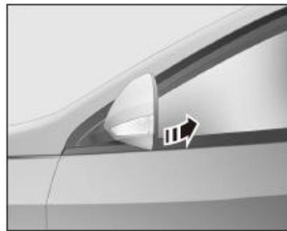
Para los modelos con retrovisores exteriores plegables manualmente, tire hacia atrás de los retrovisores exteriores con la mano para plegar los retrovisores exteriores hacia el costado del vehículo.
