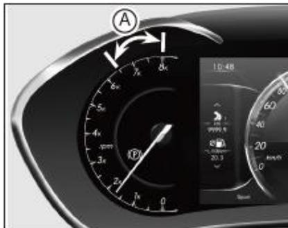
El tacómetro indica la velocidad del motor por minuto, y el valor del puntero  $\times 1000r/min$  es la velocidad del motor.
