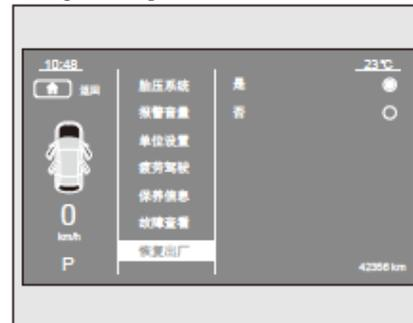
Después de ingresar a la interfaz de configuración predeterminada, presione **OK** brevemente para navegar en el ciclo usando **▲/▼**, y presione **OK** para seleccionar y regresar a la interfaz del menú. Después de seleccionar la configuración predeterminada, todas las funciones se restablecerán al estado predeterminado.
