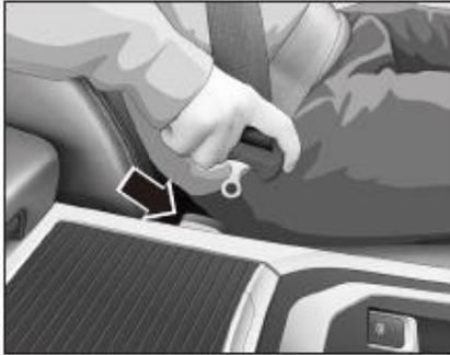
El bloqueo del cinturón de seguridad se puede liberar presionando el botón rojo en la hebilla. Después de desbloquear el cinturón de seguridad, empuje el cinturón de seguridad en la dirección del punto fijo hacia arriba y el cinturón de seguridad se retraerá automáticamente con en el retractor.
