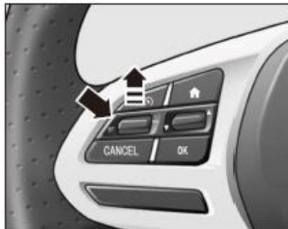
En el estado de control de cruceo, mueva el botón de configuración de velocidad de cruceo hacia arriba **+ REB** para posicionar y aumentar la velocidad de cruceo, la velocidad de cruceo aumenta 2 km/h cuando se opera una vez. Mantenga presionado, la velocidad del control de cruceo y continuará aumentando
