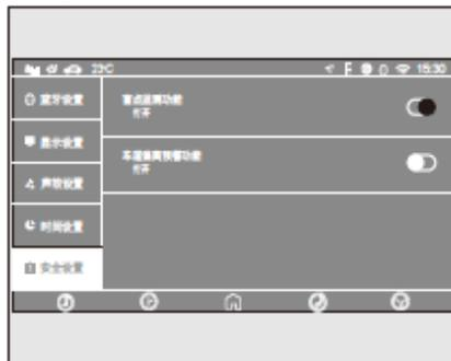
El inicio y cierre del sistema de monitoreo de área ciega se puede configurar en la pantalla de visualización multimedia.
