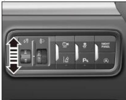
Cuando el interruptor de encendido está en la posición "ON" o el botón de arranque / parada sin llave está en el modo "RUN", y las luces de posición o la luz de cruce se encienden, la luz de fondo de todas las luces se encenderá. Mueva hacia arriba la perilla de ajuste para mejorar el brillo de la retroiluminación de los instrumentos y botones, y hacia abajo para debilitar el brillo de la retroiluminación de los instrumentos
