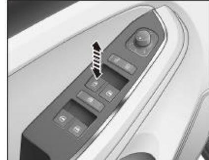
Tire hacia arriba y sostenga el interruptor, y el vidrio de la ventana delantera izquierda se eleva y suelte el interruptor y se detendrá.
