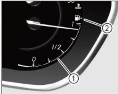
El medidor de combustible ① puede mostrar la cantidad de combustible restante en el tanque de combustible
