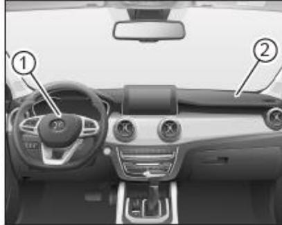
Airbag delantero del lado del conductor 1 En el medio del volante
