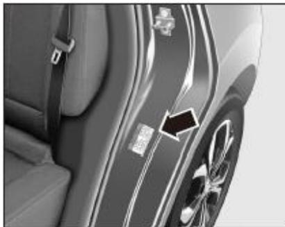
La etiqueta de datos sobre la información del neumático se pega en el lado inferior del pilar C del panel de pared izquierdo, y debe inflar el neumático de acuerdo con la presión especificada en la etiqueta de datos. Cuando verifique la presión de las llantas, debe verificar la presión de todas las llantas (incluida la llanta de refacción) al menos una vez a la semana o antes de viajar largas distancias, y la presión de la llanta de refacción debe ser de 4.2 bar.
