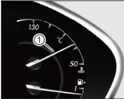
En condiciones normales de desplazamiento, el indicador de temperatura del refrigerante del motor A debe ubicarse cerca de la posición media.
