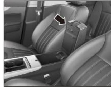
El frente del reposabrazos central se puede levantar directamente, y la caja de almacenamiento del reposabrazos central de la fila delantera se puede usar. Se puede usar para colocar algunos bocadillos sellados, bebidas y otros artículos. El tanque de almacenamiento se puede cerrar presionando hacia abajo el reposabrazos central.
