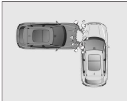
Cuando se golpea el lado exterior del compartimiento de pasajeros, se golpea ligeramente la carrocería y el airbag frontal, airbag lateral \* y el airbag de cortina lateral \* no funcionan.
