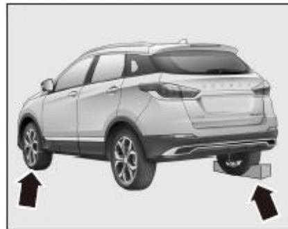
1. Coloque los topes apropiados en la parte delantera y trasera de la rueda que está en diagonal a la rueda con falla, para evitar el movimiento del vehículo cuando se levanta.
