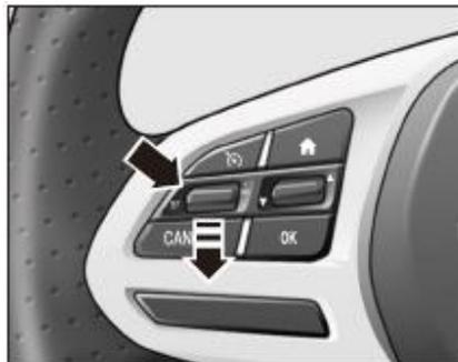
En el estado de control de cruceo, cambie la configuración de velocidad de cruceo **SET** botón hacia abajo para posicionar y reducir la velocidad de cruceo SRC, la velocidad de cruceo cae 2 km/h cuando se opera una vez. Mantenga presionado, la velocidad del control de cruceo y continuará disminuyendo.
