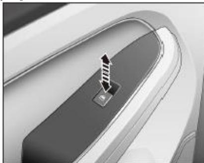
El interruptor de elevación del vidrio de la ventana del lado del pasajero se encuentra en el reposabrazos de cada puerta, y al subir o presionar el interruptor puede controlar la elevación del cristal de la ventana correspondiente.
