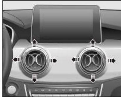
Ajuste la dirección del viento ajustando la salida de aire central en la parte superior, inferior, izquierda y derecha.
