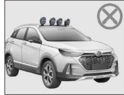
Después de la instalación de equipos eléctricos con una potencia superior a la potencia nominal, puede producirse un incendio debido al calor y cortocircuito del arnés causado por una carga demasiado grande
