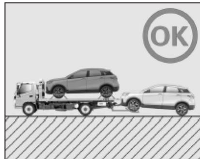
Suelte el freno de estacionamiento del vehículo defectuoso, levante y repare las ruedas delanteras.
