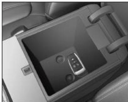
Coloque la llave inteligente en la marca de arranque de emergencia de la caja del reposabrazos central, presione el botón de arranque / parada sin llave para encender el vehículo.
