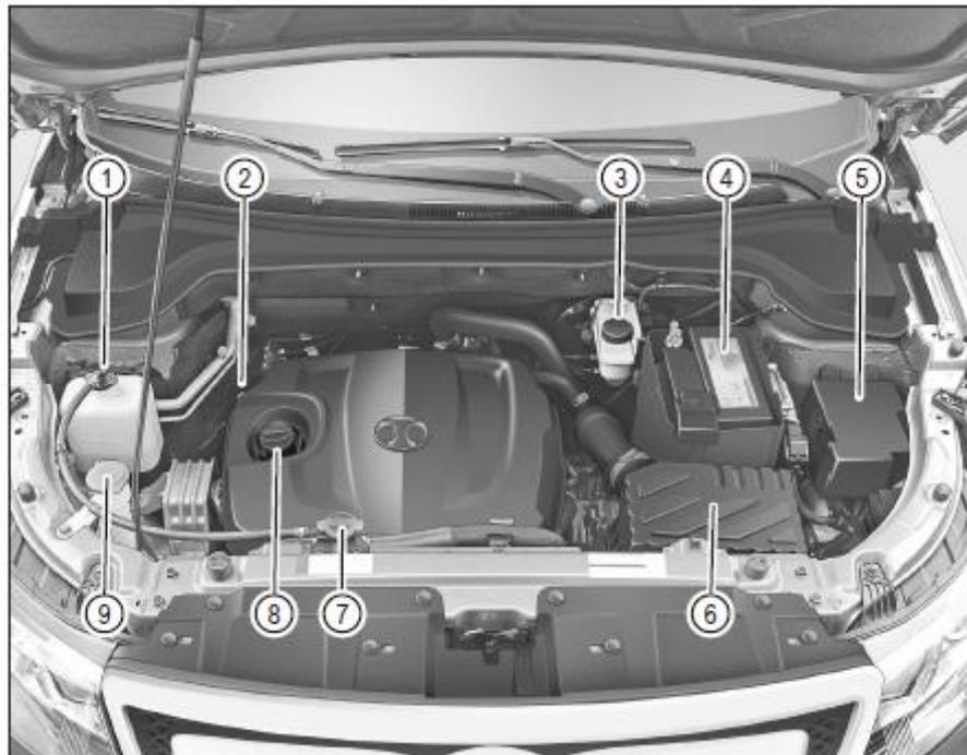
1. Tapón de llenado del depósito de refrigerante del motor
