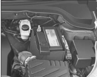
Cuando reemplace la batería, asegúrese de que la batería esté instalada correctamente, y el terminal hacia el centro del vehículo y el terminal positivo hacia adelante. Asegúrese de que la bandeja y la placa de la batería estén correctamente fijadas para evitar el movimiento
