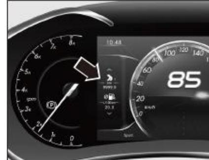
No conduzca hasta que el tanque de combustible esté completamente agotado. El suministro de combustible irregular puede provocar un fallo de encendido del motor y el combustible no quemado ingresa al dispositivo de escape. ¡El convertidor catalítico de tres vías de escape se dañará!
