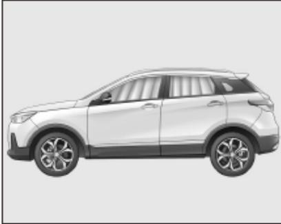
En el caso de un impacto lateral grave, el airbag de cortina lateral desplegado puede reducir efectivamente el riesgo de lesiones en la cabeza y la parte superior del cuerpo.
