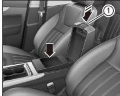
Presione el interruptor de bloqueo 1 de la parte delantera (exterior) del reposabrazos central y gire la tapa de la caja de almacenamiento hacia arriba, de modo que pueda usarse la caja de almacenamiento superior del reposabrazos central de la fila delantera. Se puede utilizar para colocar tarjetas de visita, tarjetas de reabastecimiento de combustible, facturas y otros artículos.
