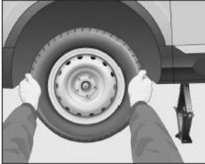
1. Alinee los orificios de instalación en la rueda de repuesto con los orificios de instalación en el disco de freno.
