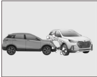
Cuando se produce una colisión lateral, el conductor y el pasajero tienen desplazamiento lateral, por lo que la bolsa de aire desplegada desde el frente no puede proteger al conductor y al pasajero, la bolsa de aire delantera puede no desplegarse, y la bolsa de aire lateral \* y la bolsa de aire lateral de cortina \* puede ser desplegado.
