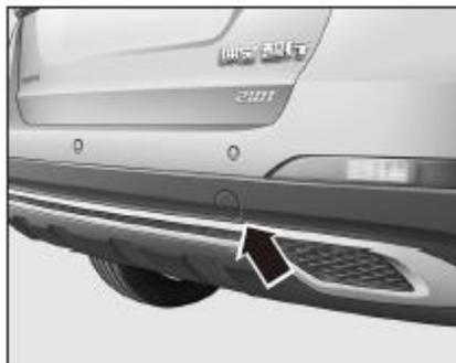
Instalación de anillo de tracción trasera.
