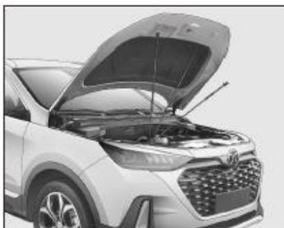
3. Abra el capó en la posición correcta, tome el manguito de goma de la barra de soporte, saque la barra de soporte de la hebilla y coloque la cabeza de la barra en el orificio ovalado en la cubierta del compartimento del motor para confirmar el soporte confiable.
