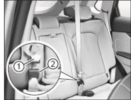
Cuando se sienta en el asiento del medio trasero, primero hale el cinturón de seguridad del retractor en la parte trasera del techo para que el lado con flecha de la lengüeta se alinee con el lado con flecha de la hebilla para bloquear el cinturón de seguridad. Lengua 1 hebilla insertada en 2.
