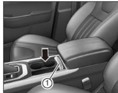
Hay un recipiente de almacenamiento detrás de la palanca de cambios, que se puede usar para colocar artículos como teléfonos móviles. Antes de usar el recipiente de almacenamiento, la tapa de la caja de almacenamiento debe abrirse hacia atrás. 1
