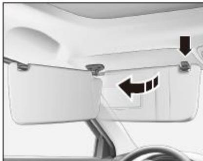
Primero baje la visera, desenganche la bisagra en el lado derecho del parasol, y luego gire la visera hacia el cristal de la ventana para proteger de la luz solar de la puerta lateral
