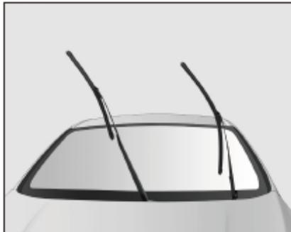
1. Levante el brazo del limpiaparabrisas del parabrisas. Coloque una toalla gruesa en la parte inferior del brazo del limpiaparabrisas para evitar daños en el parabrisas por si el brazo del limpiador rebota accidentalmente.
