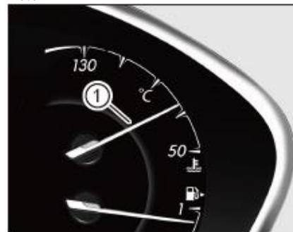
El indicador de temperatura del motor se utiliza para indicar la temperatura del refrigerante del motor.
