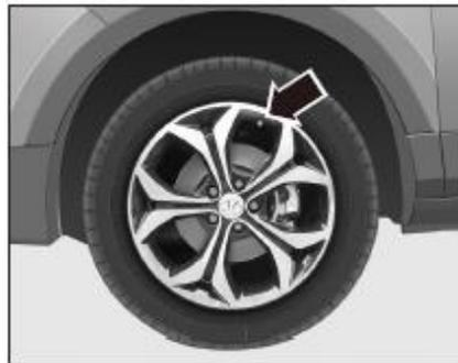
1. Retire la tapa de la válvula de la válvula del neumático y verifique la válvula del neumático con el método de jabón para detectar fugas.
