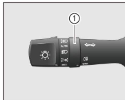
Botón Inicio/parada sin llave en el modo "RUN" y los faros se encenderán, gire la perilla de control de la luz antiniebla 1 hacia arriba, la luz antiniebla se encenderá y el indicador de luz antiniebla trasera se encenderá en el panel de instrumento. Gire la perilla de control de la luz antiniebla 1 hacia abajo para apagar la luz antiniebla trasera y el indicador de encendido de la luz antiniebla trasera.
