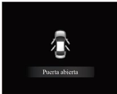
La luz indicadora se iluminará o el icono correspondiente de la puerta no cerrada se mostrará en el medio del medidor de revoluciones del panel de instrumentos (7 pulgadas).
