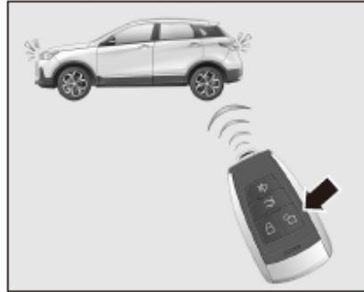
Con todas las puertas bloqueadas, presione el botón de desbloqueo una vez, todas las señales de giro parpadearán 2 veces, la posición se ilumina durante 25 segundos, las puertas se desbloquean y los espejos exteriores plegados se despliegan automáticamente (si está equipado). Después de usar la función de desbloqueo de llave inteligente, si ninguna de las cuatro puertas y dos cubiertas se abre en 30 segundos, todas las puertas se volverán a bloquear automáticamente.
