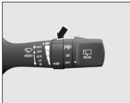
Puede ajustar la velocidad de limpieza automática del sistema girando la perilla de ajuste de sensibilidad de limpieza automática. La sensibilidad se divide en 4 niveles. Es el nivel 4 (el más rápido) cuando gira la perilla hacia arriba, el nivel 1 (el más lento) hacia el más bajo, y los niveles 2 y 3 la posición media. Ajuste la velocidad de limpieza automática para adaptarse a su hábito de conducir.
