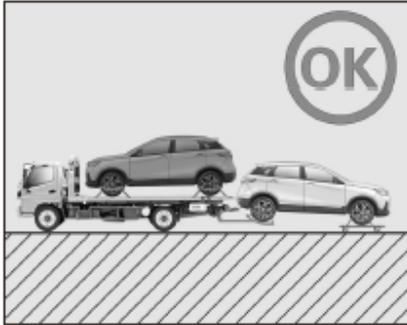
Suelte el freno de estacionamiento del vehículo defectuoso, levante y repare las ruedas traseras.
