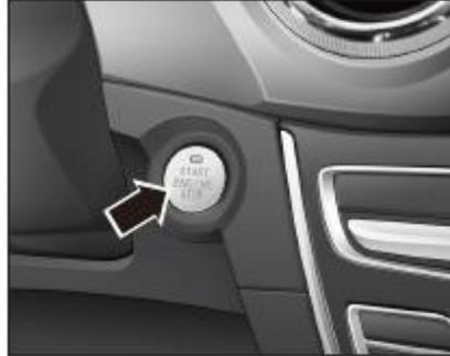
El botón de inicio / parada sin llave está en el panel de instrumentos en la parte inferior derecha del volante.
