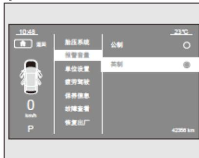
Elija "Configuración de la unidad" en la página de configuración del instrumento, presione brevemente el botón **OK** para configurar el sistema de la unidad. Cambie el botón **▲** / **▼** para elegir entre sistema "Métrico" y "Británico", presione brevemente el botón **OK** para completar la configuración. Luego presione brevemente **⬆** para regresar al menú superior, presione prolongadamente **⬆** para regresar al menú principal.
